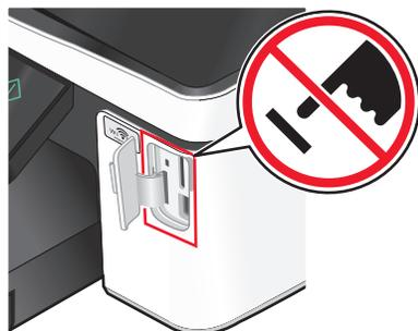
**Aviso: Danos potenciais:** Não toque em quaisquer cabos, em qualquer placa de rede, qualquer conector, dispositivo de memória ou na impressora nas áreas mostradas enquanto estiver a imprimir, ler ou escrever activamente a partir do dispositivo de memória. Poderá perder dados.
