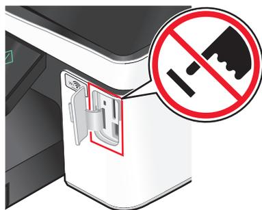
**Aviso: Danos potenciais:** Não toque em quaisquer cabos, em qualquer placa de rede, qualquer conector, placa Bluetooth USB ou na impressora nas áreas mostradas enquanto estiver a imprimir, ler ou escrever activamente a partir de um dispositivo compatível com Bluetooth. Poderá perder dados.
